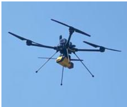
Drone multi-rotor « Tundra » d'Hexadrone équipé d'un LIDAR et installé au laboratoire EDYSAN (Source : Emmanuelle CANO)
