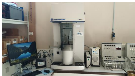
Porosimètre pour la détermination des propriétés texturale, installé à l'UCCS, Univ. Artois (Source : CPER ECRIN).
