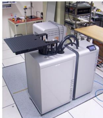
Bâti de dépôt en phase vapeur (PVD) d'Elettrovava, installé à l'IEMN à Villeneuve d'Ascq (Source CPER IMITECH).
