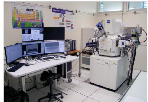
Microscope à faisceau d'ions focalisé Zeiss Crossbeam 550L, installé à l'IEMN à Villeneuve d'Ascq (Source CPER IMITECH).
