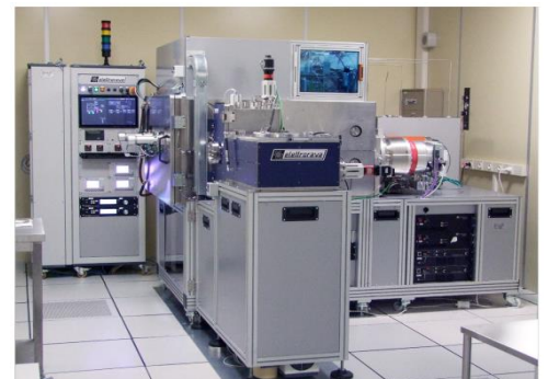
Bâti de dépôt en phase vapeur (PVD) d'Elettrovava, installé à l'IEMN à Villeneuve d'Ascq (Source CPER IMITECH).
