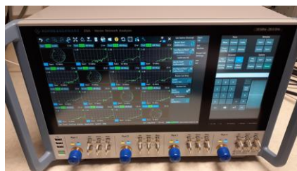
Analyseur de réseaux vectoriel pour pilotage de têtes d'extension THz, installé à l'IEMN (Source : CPER Wavetech).
