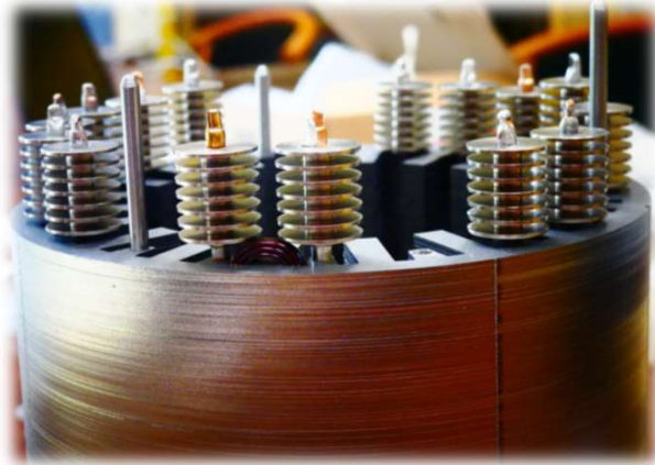
Intégration de caloducs de refroidissement au cœur de la machine
