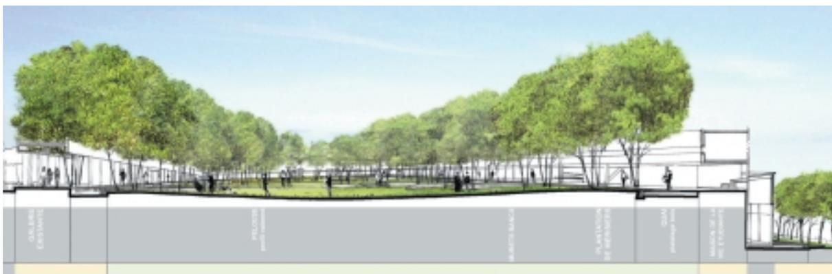
Coupe de principe du clos Vasarely (170 m x 60 m) montrant un espace légèrement décaissé, aux rives plantées de grands merisiers. Ce cloître végétal, au sol enherbé en son centre, est conçu comme une respiration.
